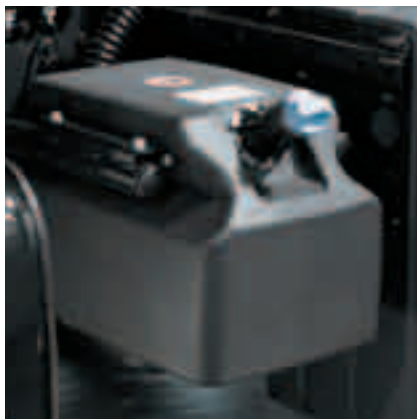
Отдельный бак AdBlue® для строительных автомобилей.
