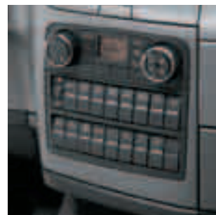
Новые элементы управления климатической установкой. Обогрев и вентиляция. Новые панели выключателей с функциональной индикацией.
