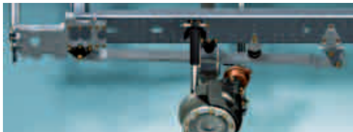
Подвеска с однолистовыми рессорами способствует снижению собственного веса автомобиля.
